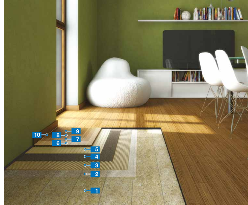
Sistema fonoisolante para o assentamento de madeira sobre pavimento existente em tijoleira
