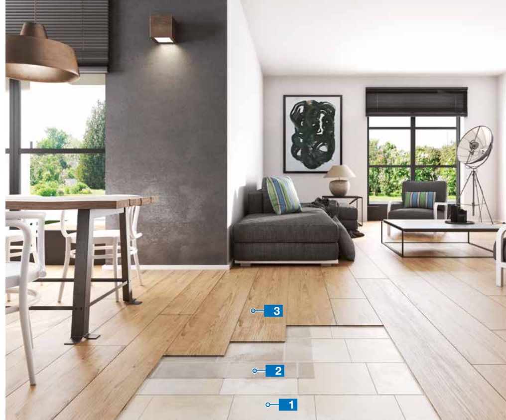
Assentamento de LVT ("Luxury Vinyl Tiles") auto-adesivos sobre pavimento cerâmico existente com juntas
