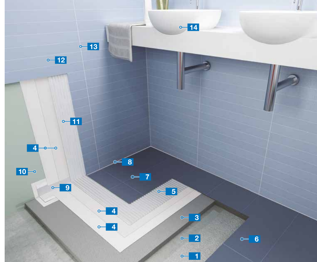
Sistema para a impermeabilização e o assentamento de cerâmica em casas de banho e locais húmidos
