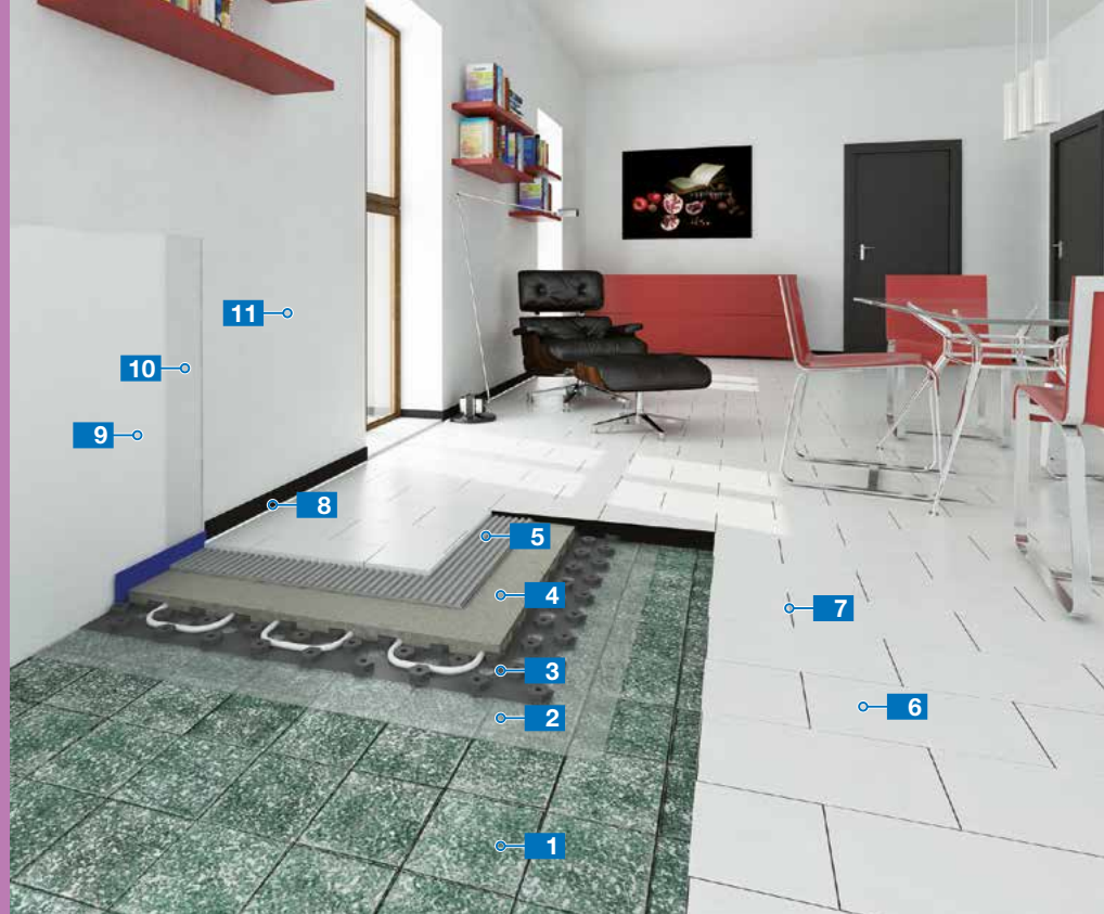
2.27 Sistema de assentamento de grés porcelânico de baixa espessura sobre sistema radiante de baixa espessura (sistema UPONOR)
